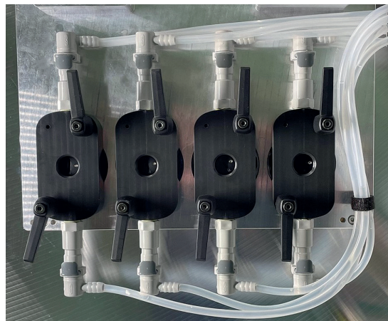
Abb. 2: Ausstattung mit vier Messzellen sowie jeweils separaten Zu- und Abläufen
