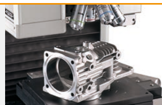
Mikrohärtebestimmung an einem Getriebegehäuse
